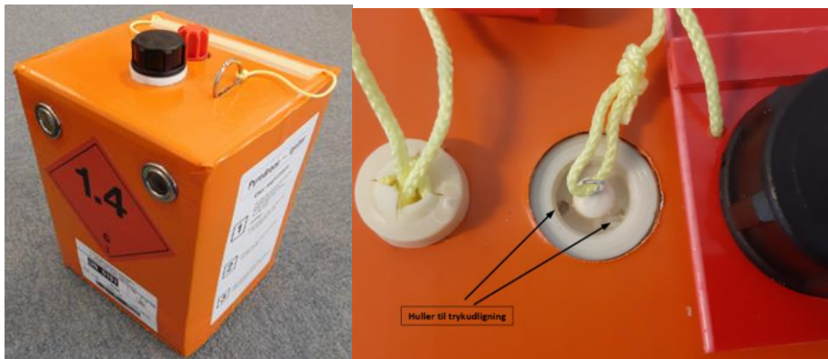
Figur 7: Igniter utviklet for bruk sammen med PyroDrone. Til høyre et nærbilde der vi ser hullene som gjør at man ikke får trykkoppbygging som blåser håndblusset ut av boksen.
