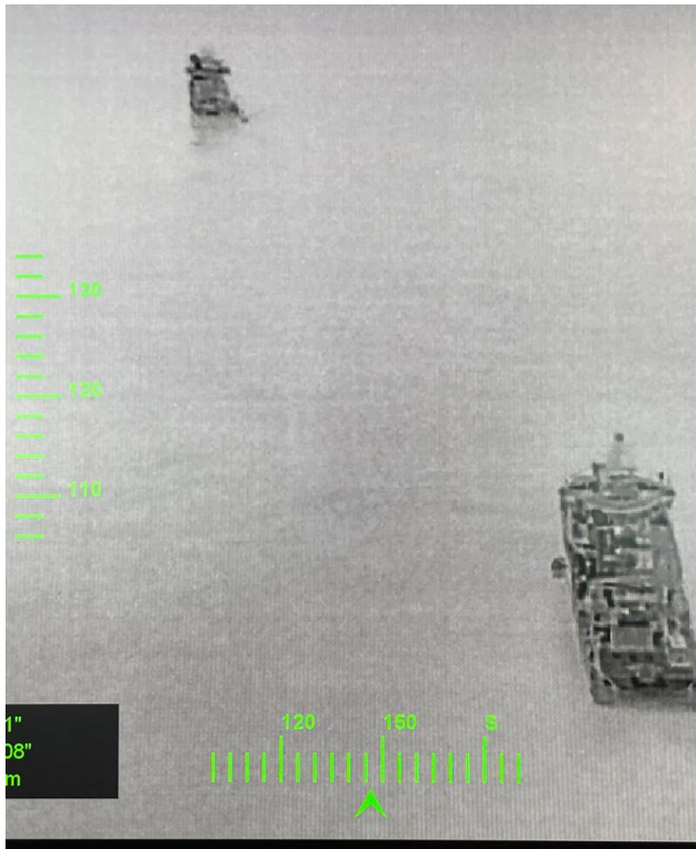
Figur 4: KV Bergen i beredskap bak NS Orla som gjennomfører forsøk. IR foto – aktivt brukt for å detektere ev. lenselekkasje.
