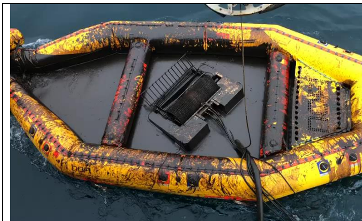
Forsøk 1 – Markleen MS 50 (børsteskimmer/multiskimmer)
