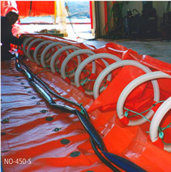
Åpen lenseduk på NO-450-S. Trykksatt spiralslange spiller ut lenseduken i overvannsdelen.
